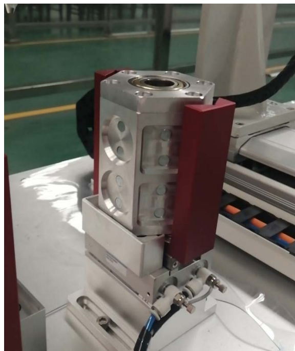
（图 6、笔筒与轴承底座安装后参照图）
