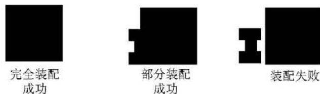
图9 侧面装配效果示意图
