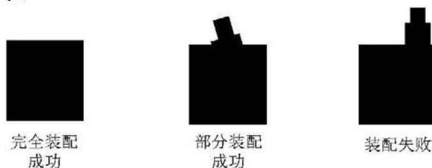
图10 顶面装配效果示意图
